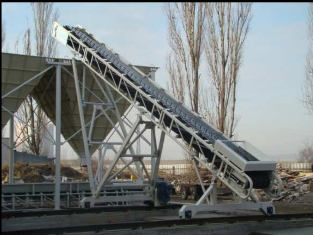
Mobile Förderbänder(Baugruppe RF) mit elektromotorischem Schwenkfahrwerken
