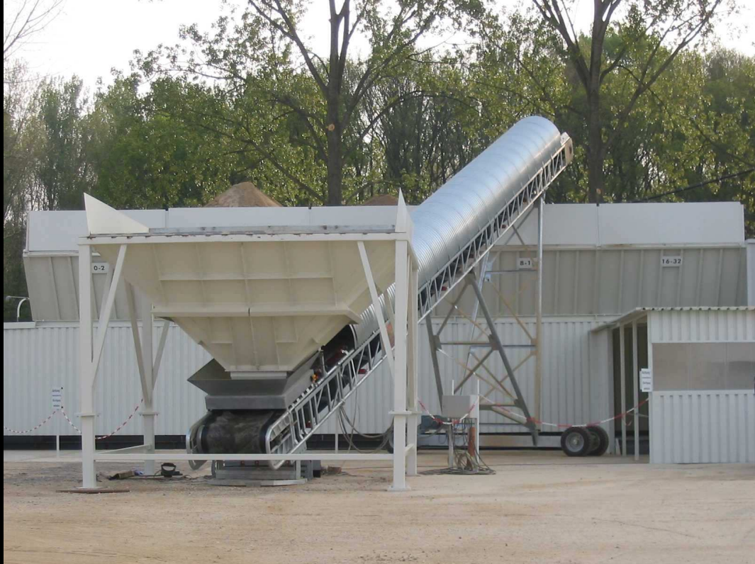
Mobile Förderbänder(Baugruppe RF) mit elektromotorischem Schwenkfahrwerken
